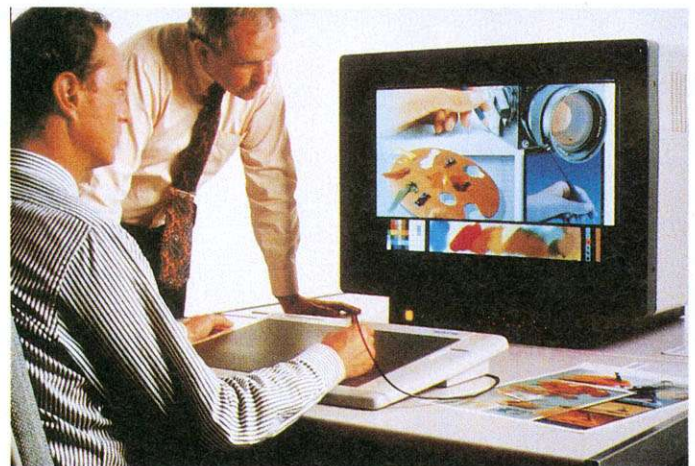
Paintbox im Einsatz: Die Grafik-Workstation von Quantel arbeitet grundsätzlich mit drucksensitivem Grafiktablett
