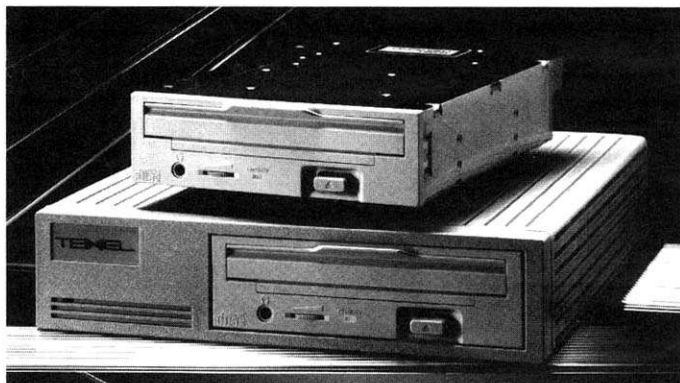
Texel DM-5024: Das Laufwerk gibt es als interne Version (oben) sowie extern im Gehäuse mit eigenem Netzteil
